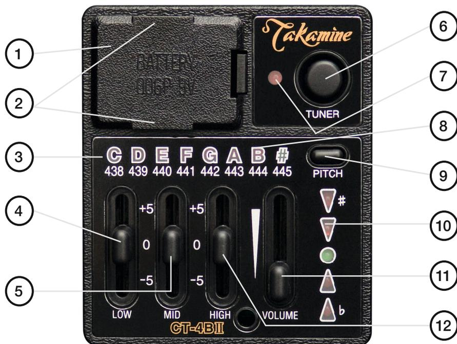
Das „Easy Out“ **Batteriefach (1)** macht den Batteriewechsel einfach und schnell. Durch Drücken der Lasche auf der Längsseite des Batteriefachs wird die Verankerung gelöst und das komplette Fach kann herausgezogen werden. Hilfreich dabei sind die „Finger-Grips“ (2) auf der Ober- und Unterseite des Fachs. Auf der Innenseite des Batteriefachs zeigt das Symbol + an, wie die Batterie eingesetzt werden muß.
